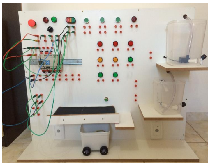
Figura 10 – Bancada preparada para simular o sistema de controle de tráfego.
